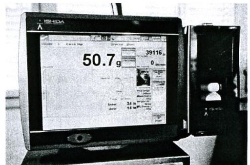
Die finale Gewichtskontrolle erledigen an beiden Verpackungslinien Hochleistungskontrollwaagen des Typs Ishida DACS-W-012. Die Maschinen haben einen Wägebereich von 10 g bis 1.200 g und sorgen mit einer Genauigkeit von 0,2 g für Sicherheit bei Hunziker.
