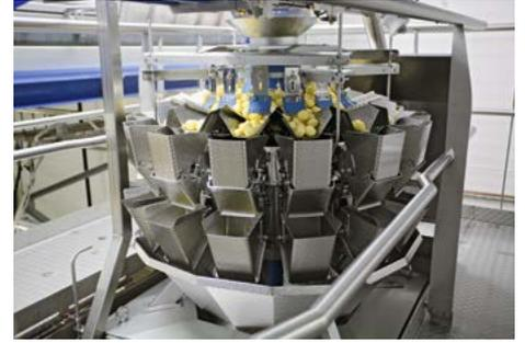
Die Mehrkopfwaage CCW-RV ermöglicht höchste Präzision für Fixgewichte mit niedrigen Stückzahlen.
