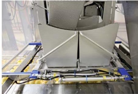
Die Gemüse werden von der Verteileinheit direkt an eine Tiefziehmaschine übergeben.
