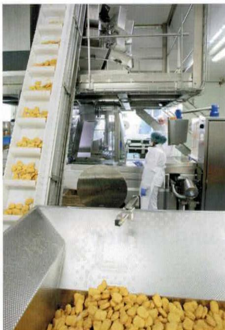
Über einen steilen Steigförderer gelangt das Produkt von oben auf die Waage
