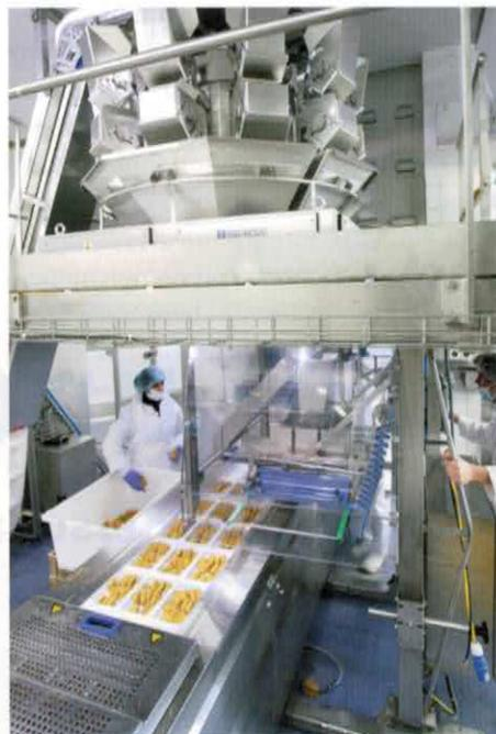
Die Waage steht auf einem Podest, darunter befindet sich die Tiefziehmaschine
