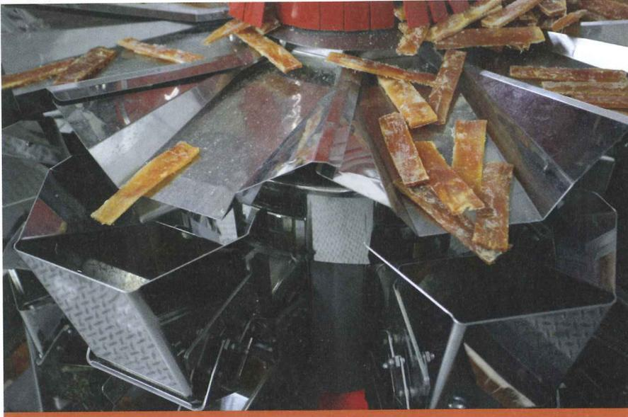
Die Mehrkopfwage Ishida CCW-RS hält die sperrigen Kausticks optimal im Fluss.
