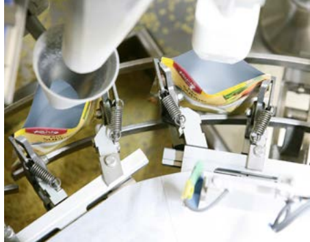
Die Neigungswinkel der Abfülltrichter wurden so gewählt, dass die Suppeneinlagen mit maximaler Geschwindigkeit in die Beutel fallen.
