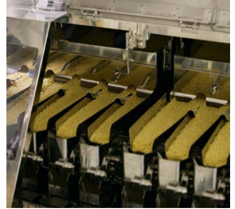
Die Mehrkopfwaage hat zwölf Wiegeköpfe und 24 Wiegeschalen.
