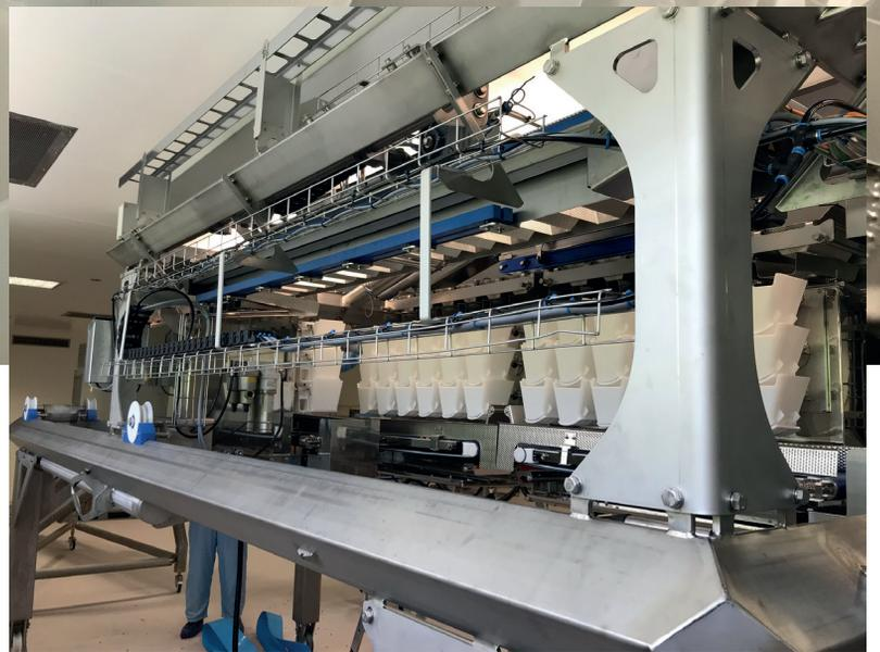
*Die beiden Linearwaagen funktionieren in Kombination wie vier einzelne Waagen.*
