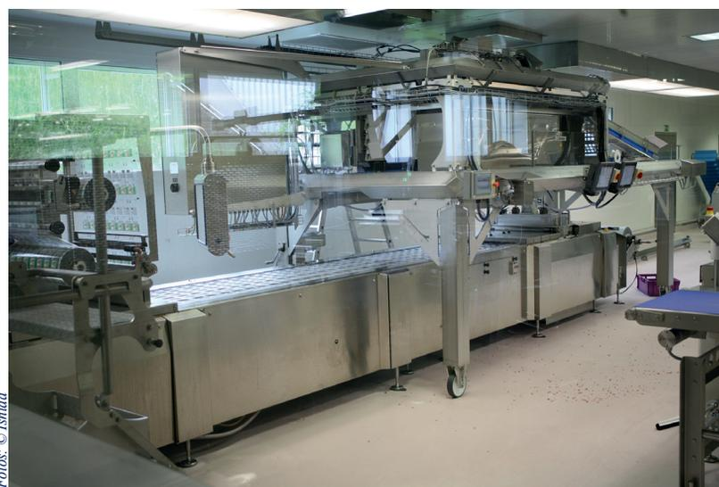
Kompaktlösung für die Abfüllung: Die Waagen CCW-R2 ruhen auf einer fahrbaren Tragkonstruktion.
