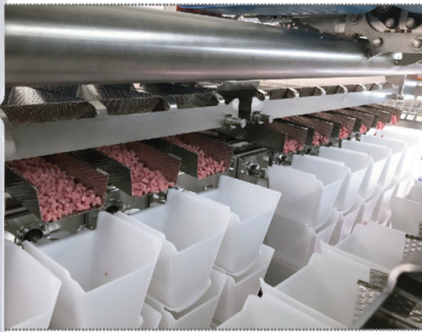
Über vibrierende Rinnen gelangen die Schinkenwürfel zu den Wiegeschalen.
