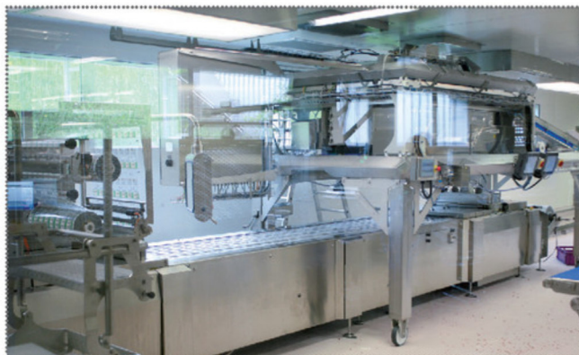
Die Waagen CCW-R2 ruhen auf einer fahrbaren Tragkonstruktion.
