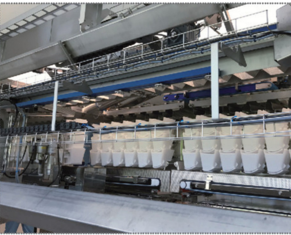
Die beiden Linearwaagen funktionieren in Kombination wie vier einzelne Waagen.
