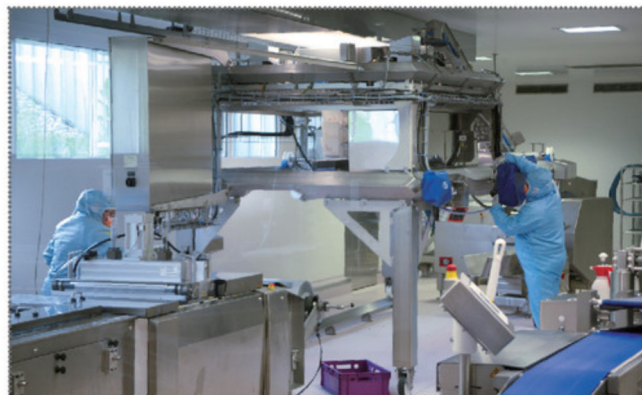
Die Verpackung im Reinraum limitiert den Platz für die Anlage.
