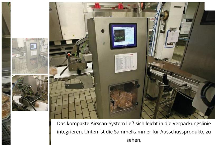
Das kompakte Airscan-System ließ sich leicht in die Verpackungslinie integrieren. Unten ist die Sammelkammer für Ausschussprodukte zu sehen.
