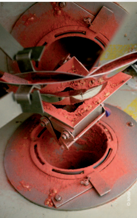
Die Speicherschale unter der Waage sammelt das Produkt vor dem Abwurf in das Rohr zum Verteilsystem
