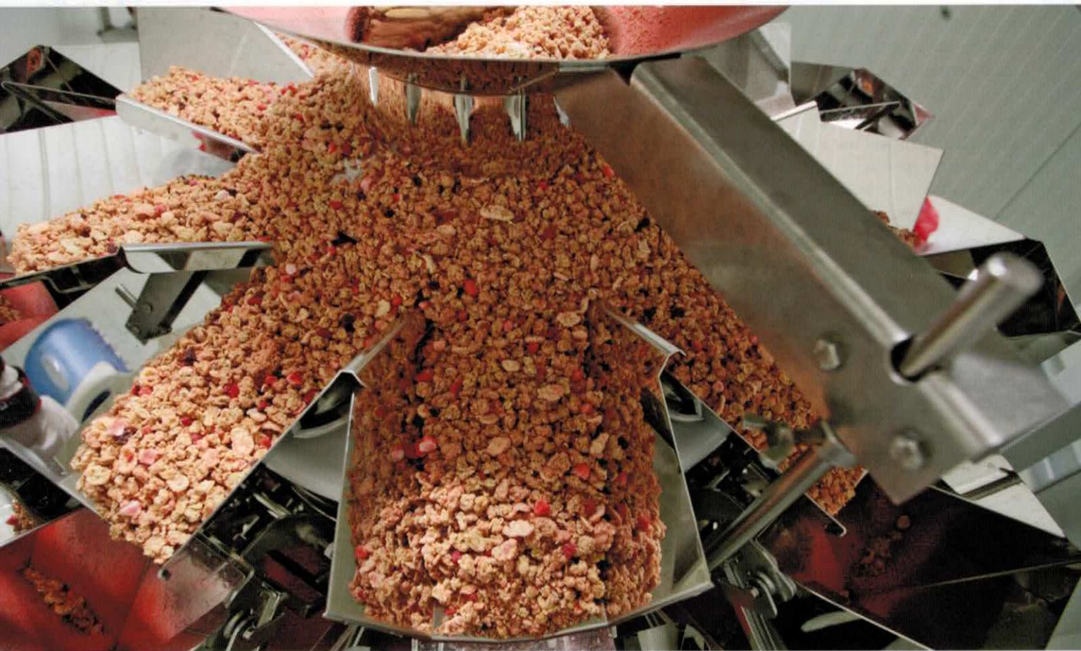
Die Cerealien gelangen bei der Ishida-Mehrkopfwage vom vibrierenden Verteilteller gleichmässig zu den Schalen der Waage. (Bild: Ishida)
